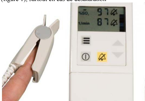
Figure 1 : Oxymètre de pouls et positionnement au doigt
