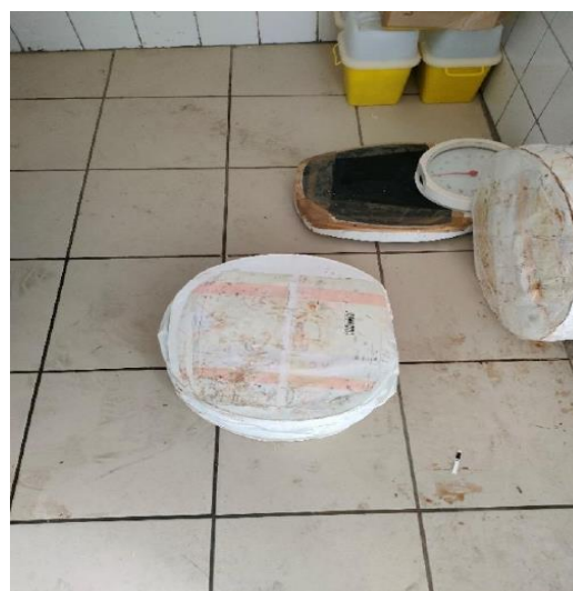
Figure 5 : Galettes de DASRI stérilisées et déformées après passage dans le banaliseuse (©Ebatetou)
